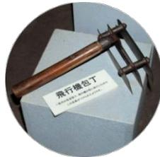
(江戸時代から明治時代前半)。ケヤキを輪切りにした海苔切り台(明治後半)。二〜三枚の刃がついた飛行機包丁(昭和)。何枚かの刃を着けたツキ包丁(飛行機包丁)の改良型。
